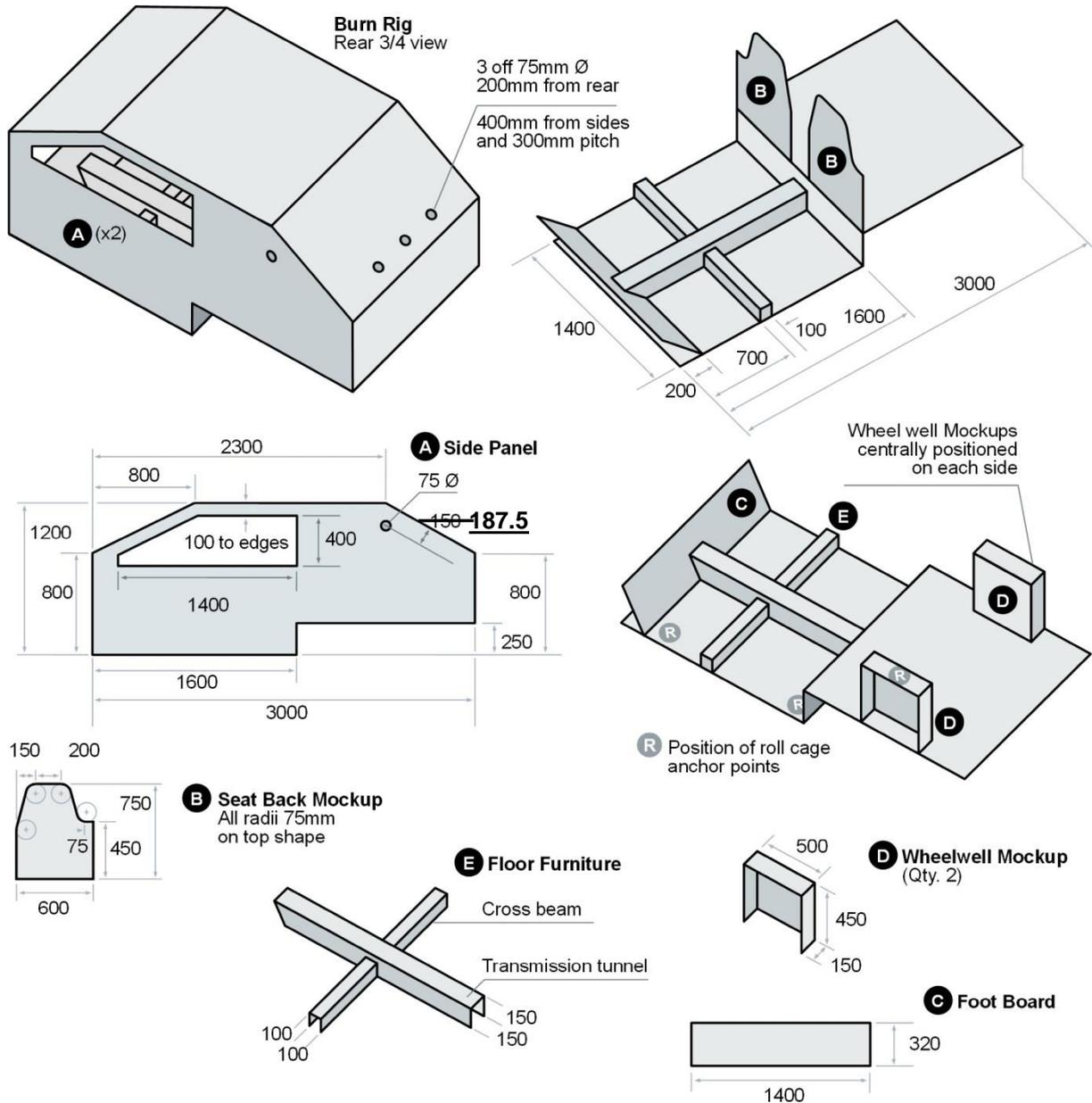
Figure A1. Banc d'essai pour l'essai d'incendie dans l'habitacle
