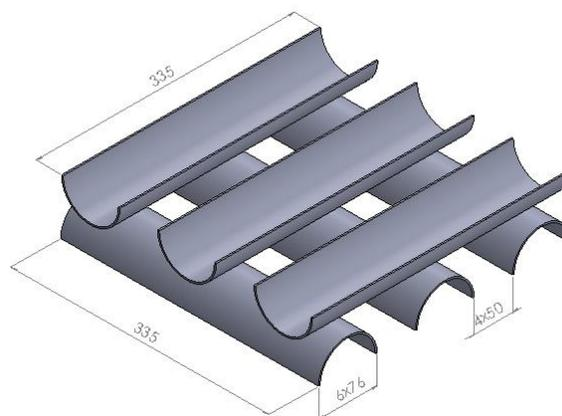
Figure 1. Assemblage en plastique pour l'essai d'incendie dans l'habitacle
