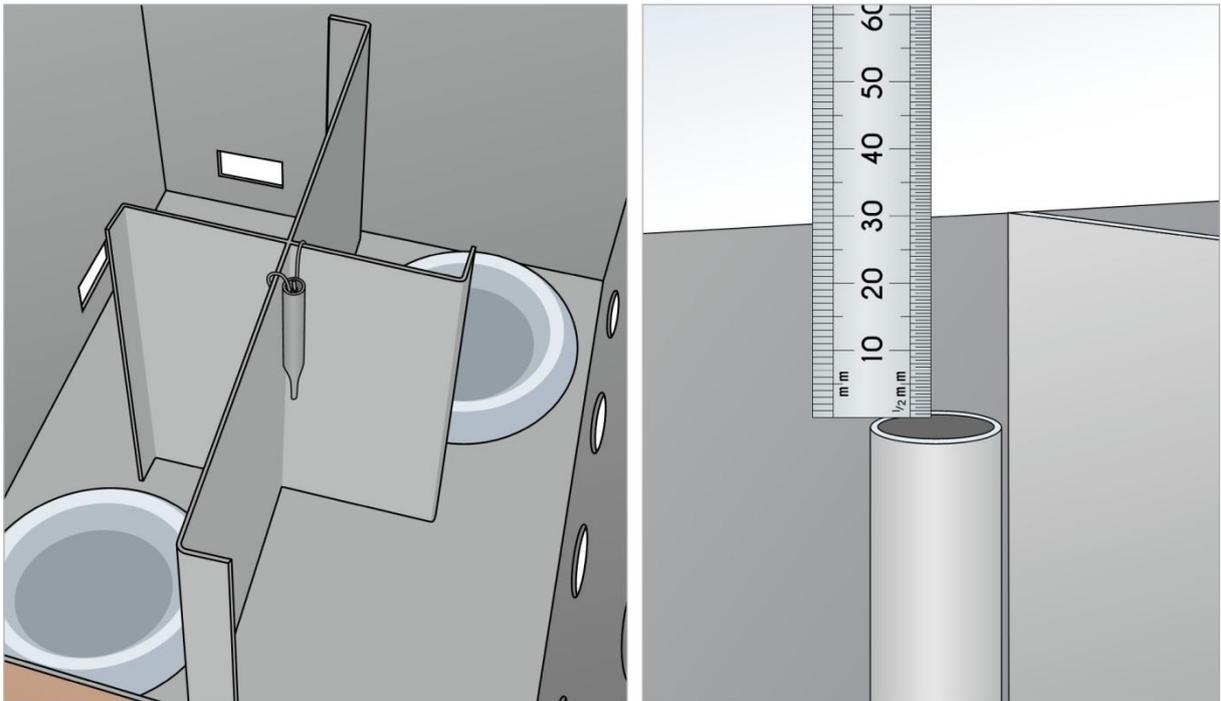
Figure B 4. Thermocouple et positionnement du tube
