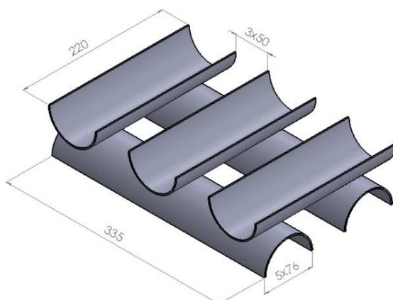
Figure 2. Assemblage en plastique pour l'essai d'incendie dans l'habitacle
