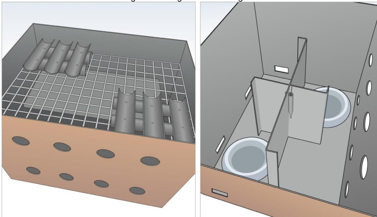
Figure B 2. Treillis au-dessus du couvercle de la cloison soutenant les assemblages en plastique
